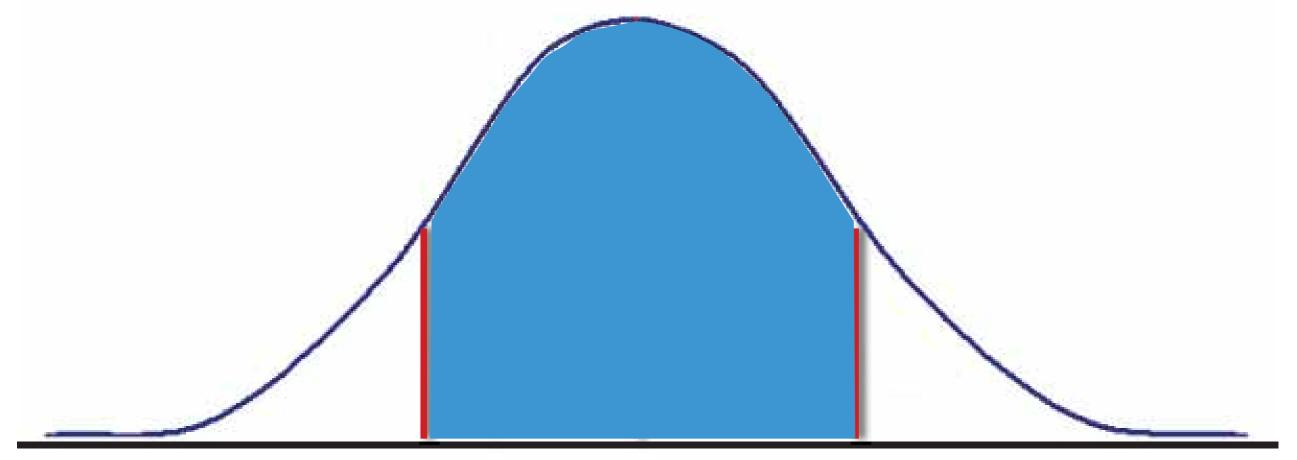
$$\overline{x} - s_x \quad \overline{x} \quad \overline{x} + s_x$$
